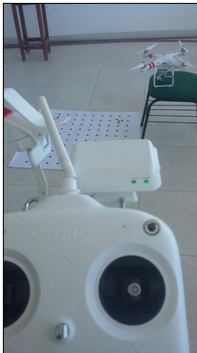
Figura 2 – Realização da calibração da câmera do VANT quadrotor FC 200
