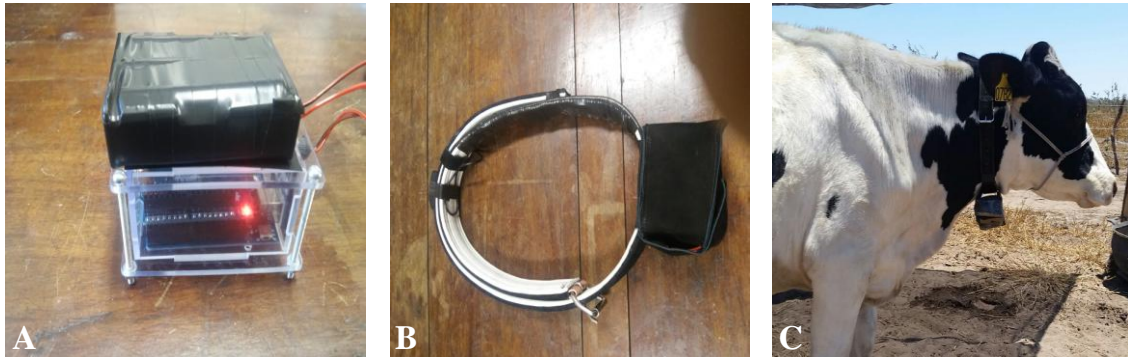
Figura 2: Hardware do sistema desenvolvido (A); Protótipo experimental da coleira GPS (B); Coleira GPS presa ao pescoço do animal (C).
