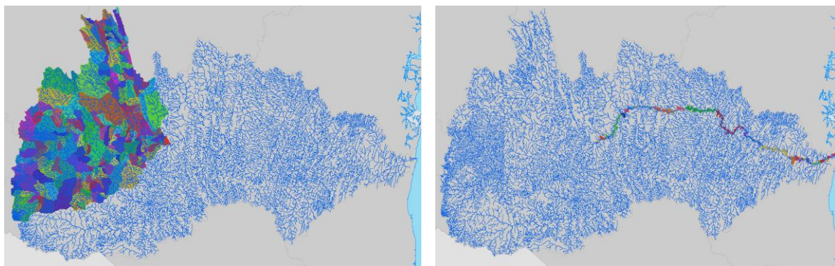
Figura 11 – Consulta espacial de um determinado ponto à montante e Figura 12 – Consulta espacial de um determinado ponto à jusante.
