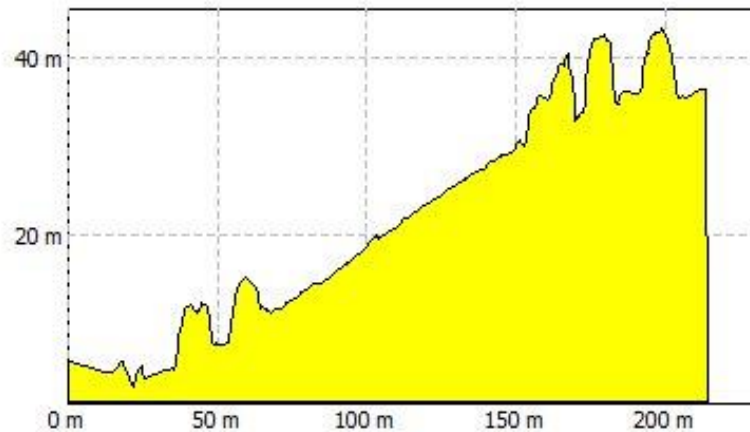
Figura 3 – Perfil longitudinal do terreno.
